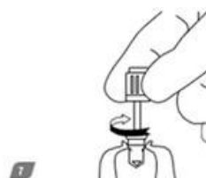
7 Entfernen Sie die Abdeckkappe vom Verschlussstopfen und schrauben Sie sie mit dem Prothetikendrehler (07-EG05; 07-EG10; 07-EG20; 02EGM10; 02EGM05) auf das Implantat.
