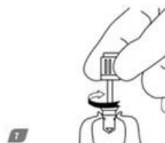
7. Αφαιρέστε τη βίδα του καλύμματος από το βύσμα φίλα και βιδώστε το στο εμφύτευμα μέσω του προσθετικού οδηγού (07-EG05, 07-EG10, 07-EG20, 02EGM10, 02EGM05).
